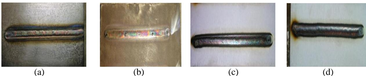
Fig. 4 Photograph of weld bead on workpiece (a) without flux (b)  $MnO_2$  flux (c)  $TiO_2$  flux (d)  $SiO_2$  flux
